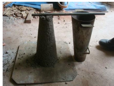
Figura 4 - Vista do abatimento zero
